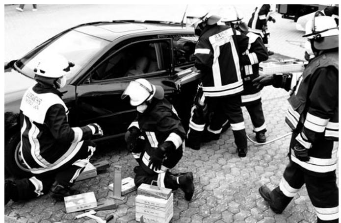
*Der hydraulische Spreizer kann Autokarosserien in Stücke reißen und muss schon deshalb besonders fachkundig bedient werden*
