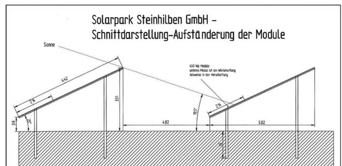
Die Solarmodule werden mit 25 Grad Neigung nach Süden aufgeständert. Die Kräuter-Wiesenmischung unter den Modulen kann dadurch mit Schafen beweidet werden. Auch der umgebende Zaun weist eine Schlupfhöhe von 20 Zentimetern am unteren Rand auf, so dass die Anlage für Kleintiere keine Einschränkung darstellt
